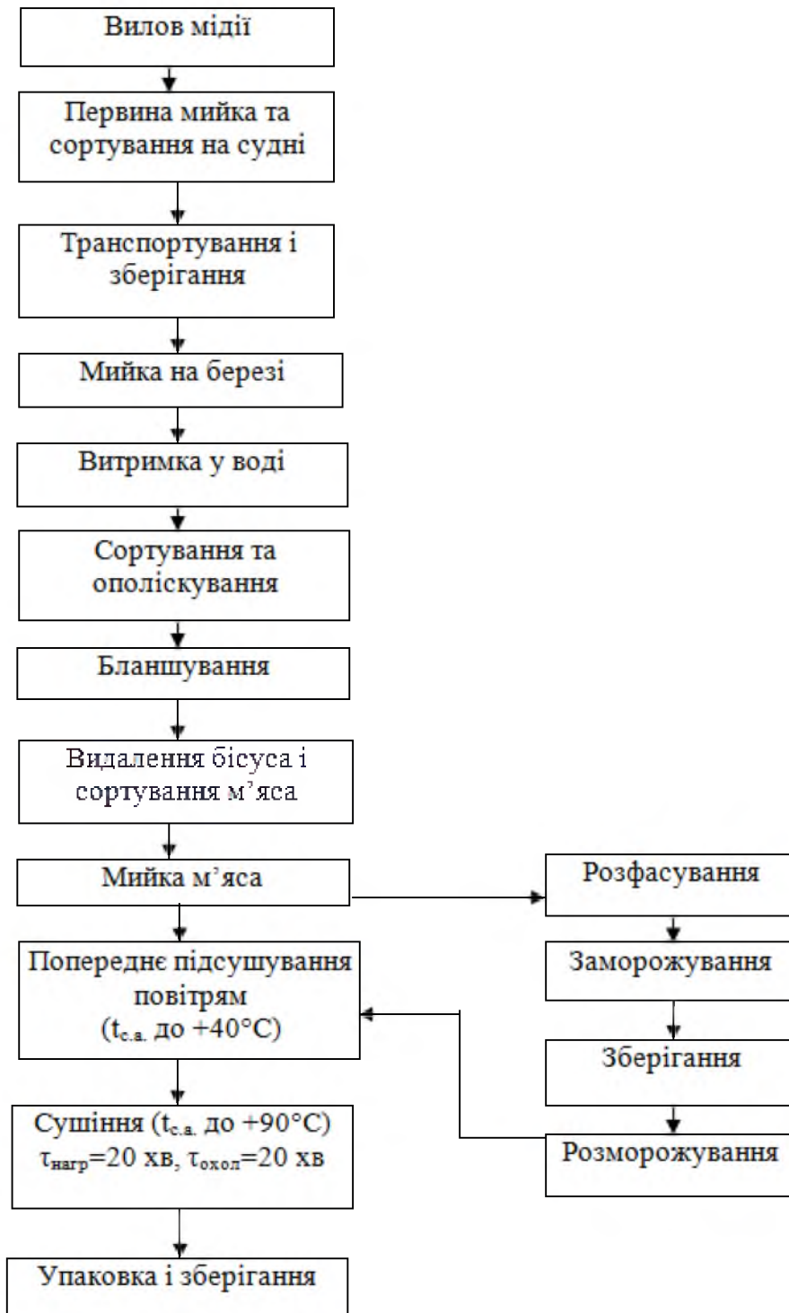
Рис. 1. Технологічна схема виробництва сушеного м'яса мідії.
