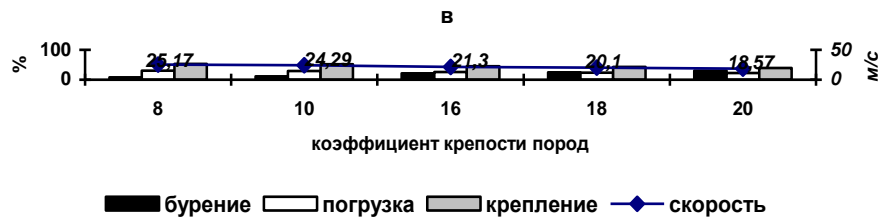
Рис. 3. Удельный вес времени операций и скорость проходки ствола диаметром 8 м при различной крепости пород: а - при P = 2 \text{ м}^3/\text{ч} ; б - при P = 4 \text{ м}^3/\text{ч} ; в - при P = 10 \text{ м}^3/\text{ч}
