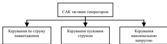
Рис. 2. Функції системи автоматичного керування тяговим генератором
