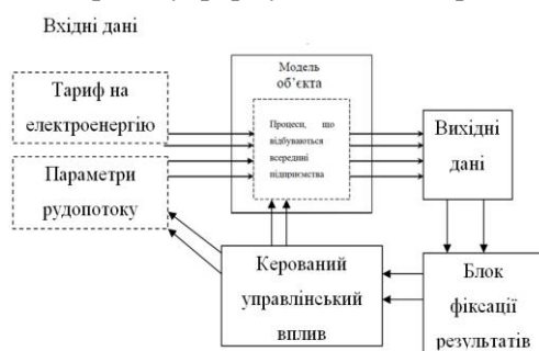
Рис. 1. Детальна структура моделі дослідження процесу формування собівартості продукції дробарних фабрик
