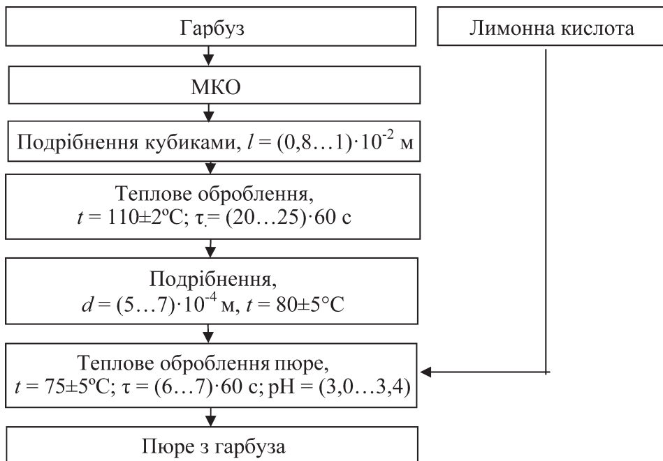
Рисунок 5 — Технологічна схема одержання пюре з гарбуза
