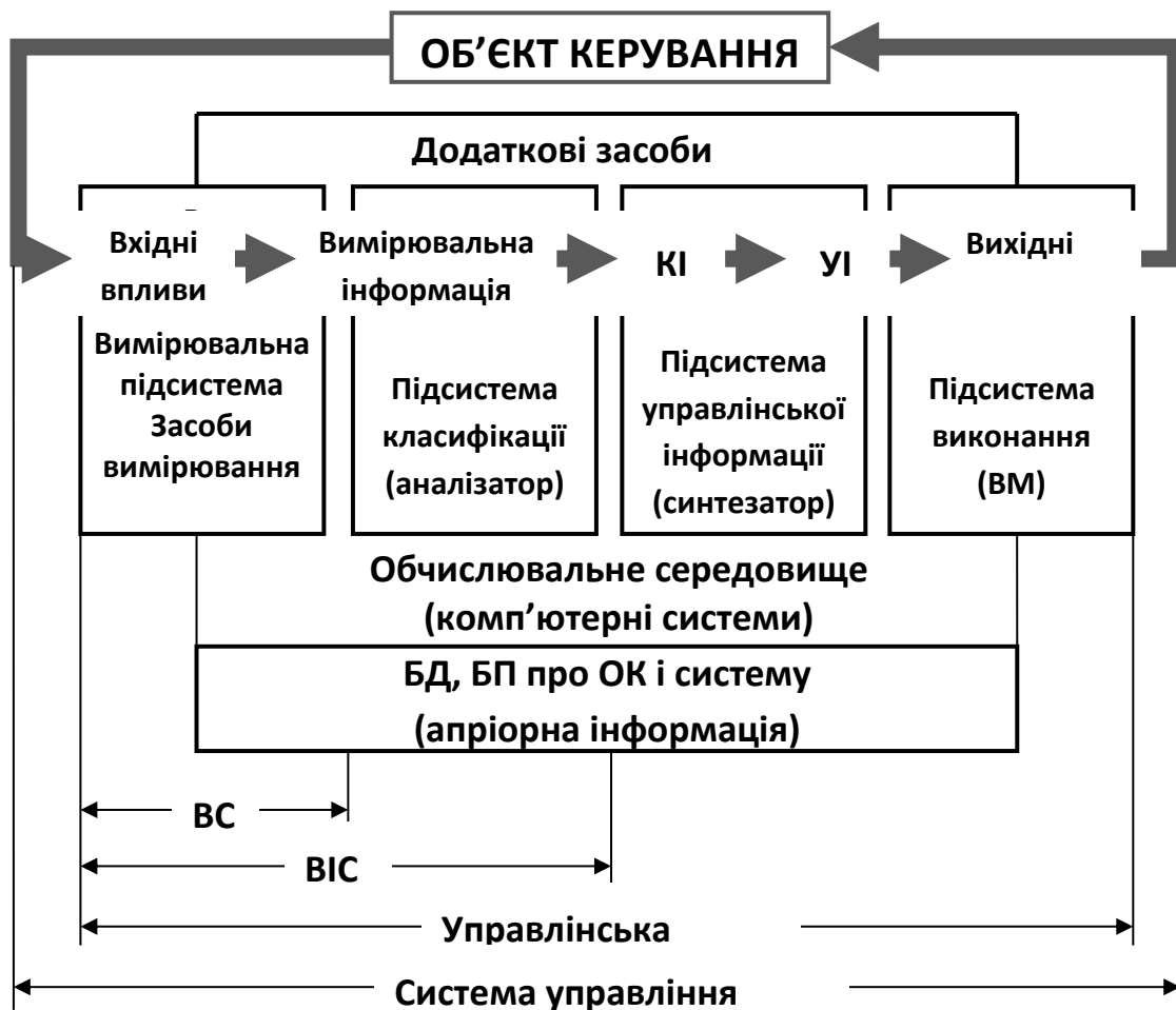
Рисунок 8.2 - Структура перетворення інформації в системі управління підприємством: ВС – вимірювальна система; ВІС – вимірювальна інформаційна система; БД – база даних; БП – база прецедентів; КІ – класифікаційна інформація; УІ – управлінська інформація; ВМ – виконавчі механізми
