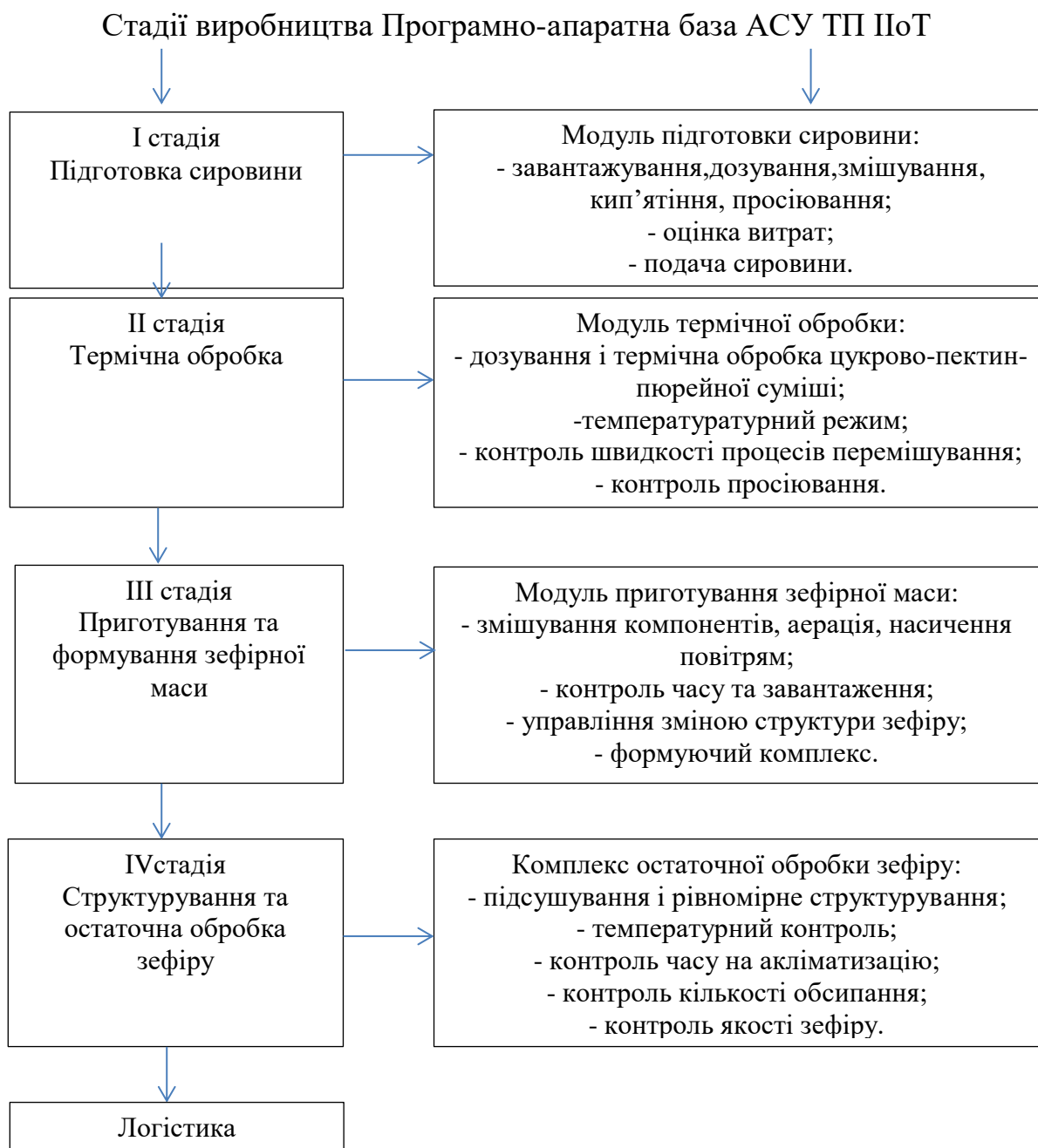
Рисунок 23.1. Запропонована схема лінії для виробництва зефіру з автоматизованою системою управління технологічним процесом з використанням промислових інтернет-речей АСУ ТП ІоТ.
