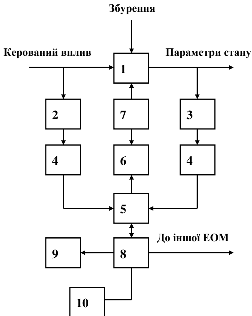
Рисунок 7.7. – Структурна схема мікропроцесорної системи керування з мікро-ЕОМ:
