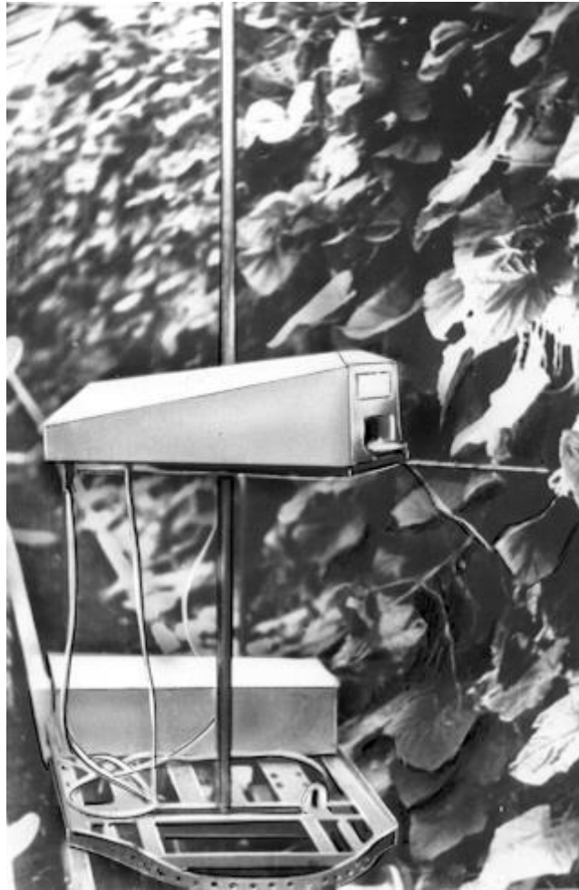
Рисунок 14.4. Робототехнічна система збирання тепличних огірків
