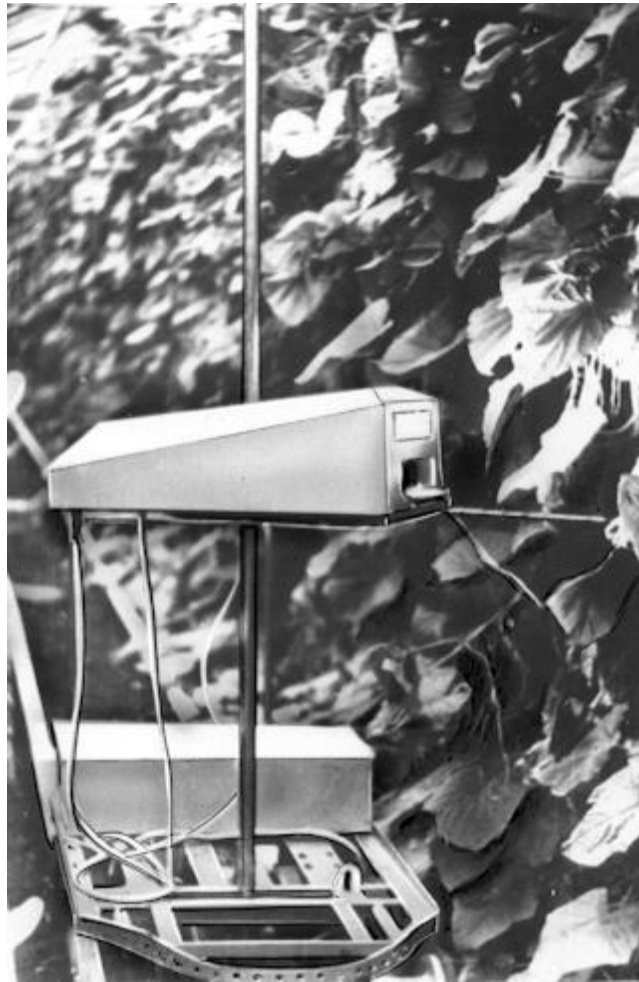
Рисунок 14.4. Робототехнічна система збирання тепличних огірків
