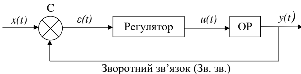
Рисунок 2.3. – Блок-схема САР за відхиленням
