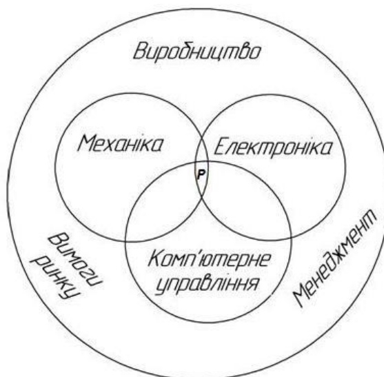
Рисунок 14.1. – Синергетичне Р-об'єднання механічних, електричних, електронних і комп'ютерних компонентів
