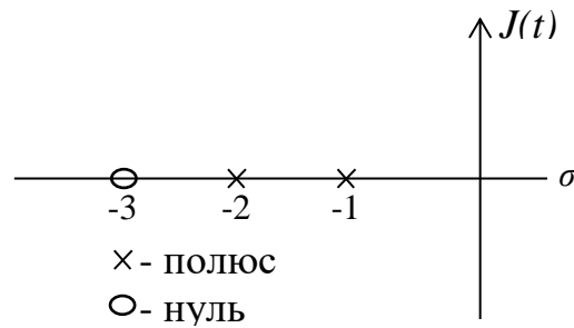
Рисунок 3.5. – Розташування полюсів та нулів на p -площині
