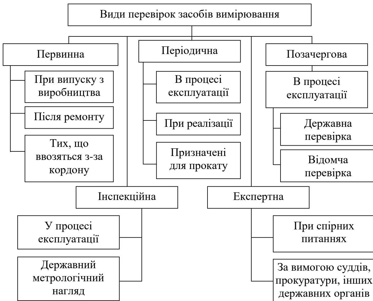
Рисунок 3.1 – Види перевірок засобів вимірювання
