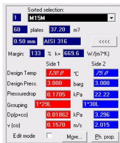
Рис. 30 – Розрахунок теплообмінника у режимі «Liquid cooling»
