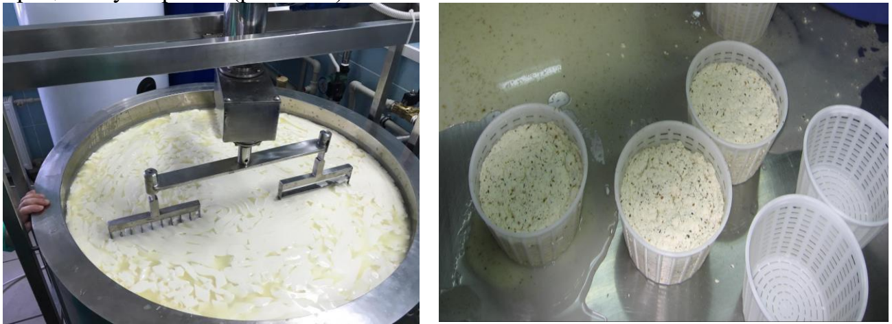
Рис. 3.20 – Перший етап видалення сироватки: а) в процесі розрізання згустку; б) в процесі формування сирної головки
