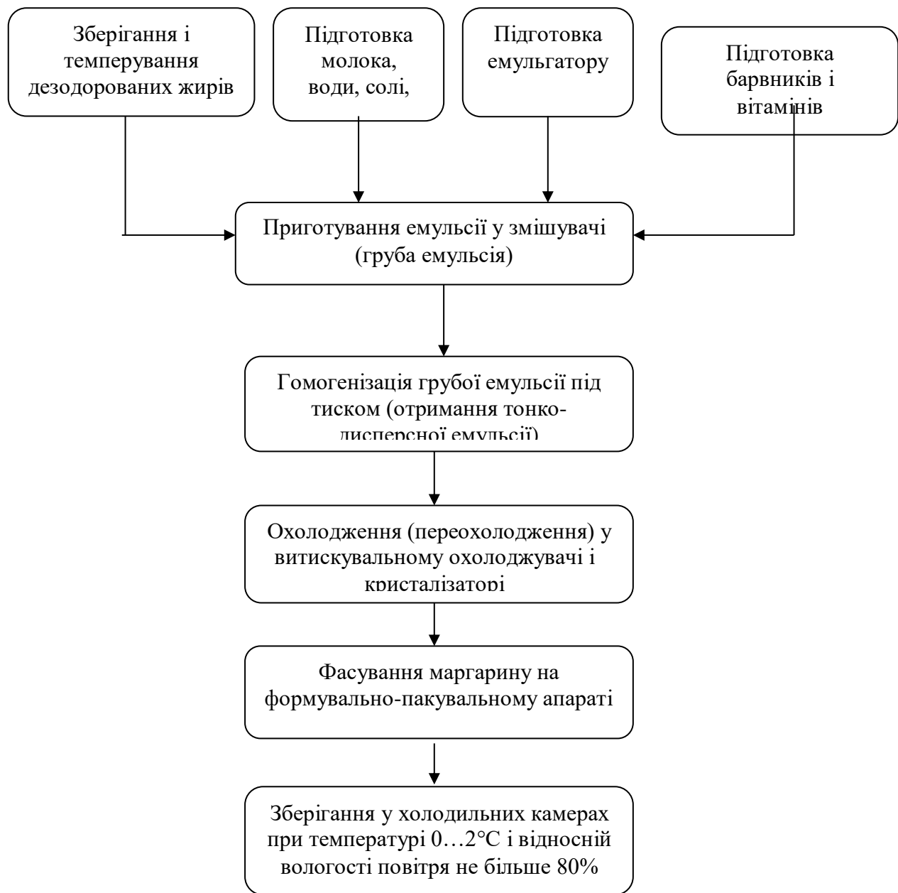
Рисунок 1.6 – Технологічна схема виробництва маргарину методом переохолодження
