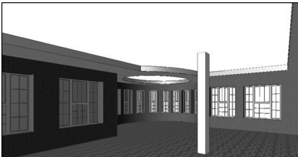
Рисунок 2.65 – Готові багатокутний та циліндричний отвори в перекритті
