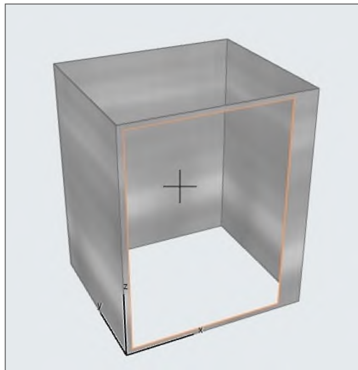
Рисунок 2.16 – 3D-вигляд отвору в стінці огороження конвекційної шафи
