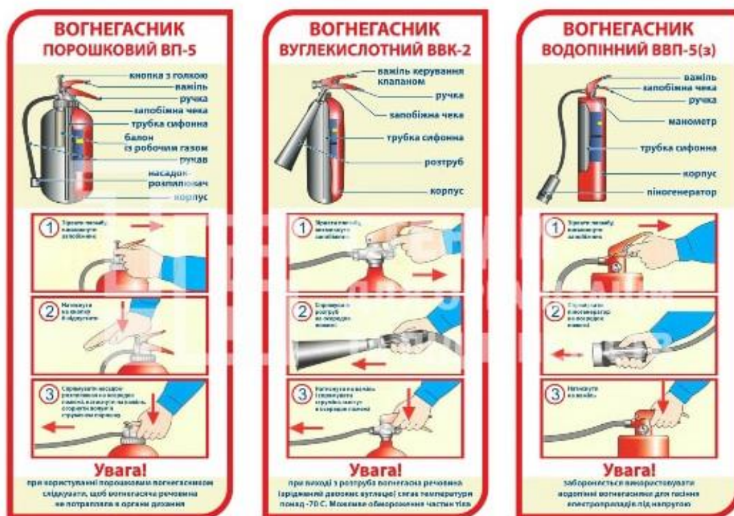
Рисунок 16 – Види вогнегасників за вогнегасною речовиною
