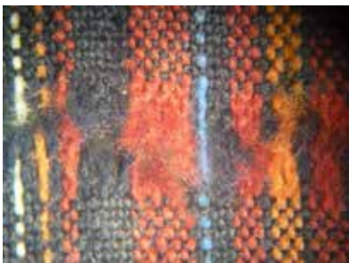
Рис. 8. Збільшене зображення збігу кінцівок ниток між фрагментом тканини та фрагментом сорочки (у кососпрямованих променях штучного освітлення)
