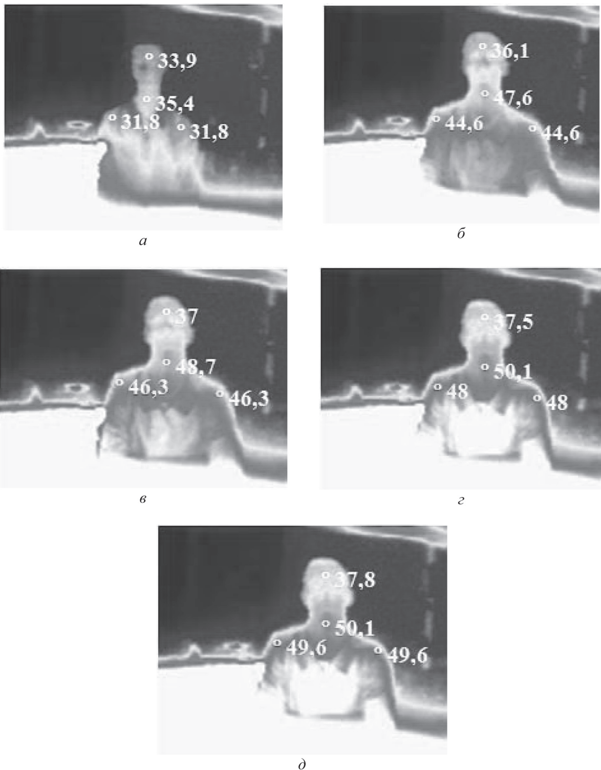
Рисунок 2 — Тепловізійні зображення працівника в полі теплового випромінювання від жарової поверхні електроплити ЕП-2М в різні моменти часу
