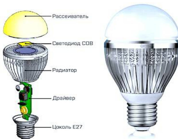
Рисунок 5.7 – Схема світлодіодної електричної лампи та її форма
