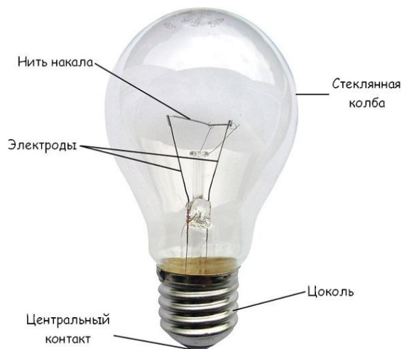
Рисунок 5.1 – Схема електричної лампи розжарювання
