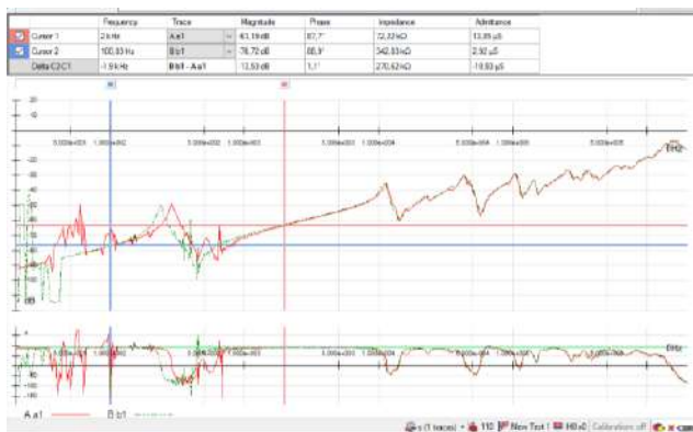
Рис. 2 – Графіки залежності діагностичних частотних параметрів трансформатора ТМ – 6300/110 від частоти (отримані шляхом використання приладу FRAnalyzer)
